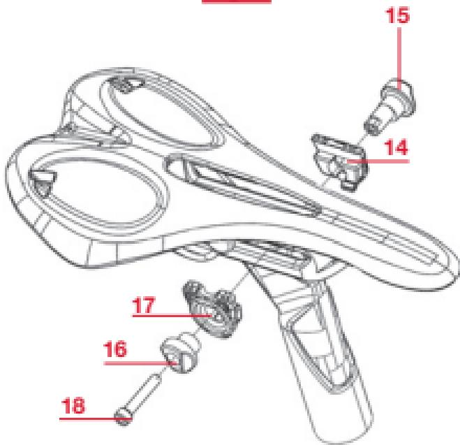
Sincerarsi che le flange **(14-17)** abbraccino perfettamente la parte superiore ed inferiore della forchetta **(10)** e che le orecchiette delle stesse flange siano rivolte verso l'alto (**Fig.F e Fig.G**).
